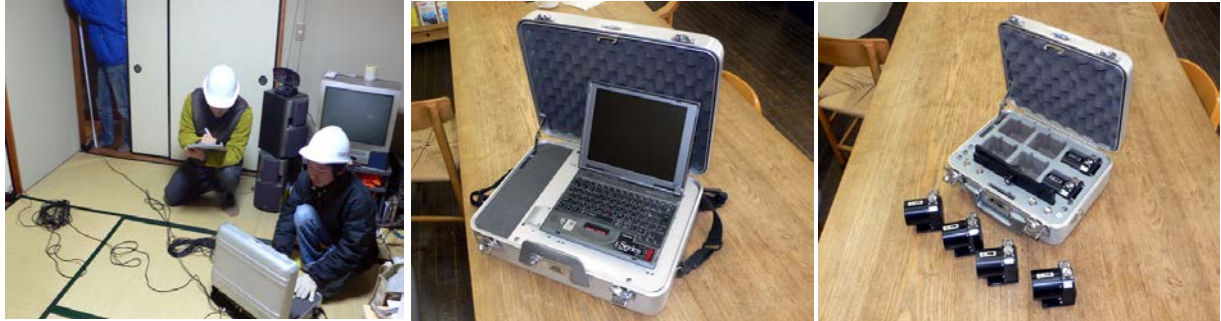
写真 2. 1. 1 常時微動測定の様子(左)、データロガー(中央)、センサー(右)
